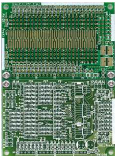
写真 2-6 デュアル／クワッド用 オペアンプ基板PX1010との 連結使用
